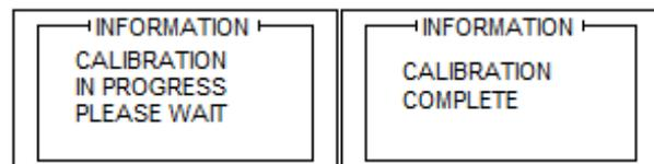
オフセット計測が成功した場合は上記の画面が表示されます。これにより、True Head (方位) が正しい値になります。これ以降、GPS アンテナの位置は動かさないようにしてください。
