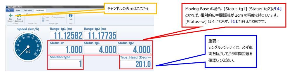
VBOX Test Suite を起動して、オンラインモードにします。 → ディスプレイ上に [Status-tg1] と [Status-tg2] と [Status-sv] を表示します。 (自車の情報は[Solution type]で確認が可能です。)
