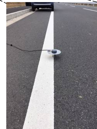
道路上に金属板とともに設置した GPS アンテナ
