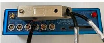
④ VBOX3i の DIN と D コネクタを接続して使用します。
