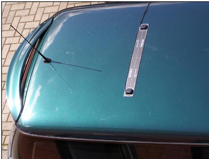
**Antenna A** がすべての計測の基準となるアンテナになります。また、スリップ角は Antenna A の位置で計測されます。もし、車両の中心でスリップ角を図りたい場合は、Antenna A を車両中心へ、Antenna B をさらにフロント側（前方）へ取り付けなければなりません。
