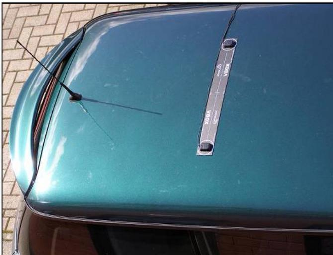
**Antenna A** がすべての計測の基準となるアンテナになります。また、スリップ角は Antenna A の位置で計測されます。もし、車両の中心でスリップ角を図りたい場合は、Antenna B をフロント側（前方）へ取り付けなければなりません。
